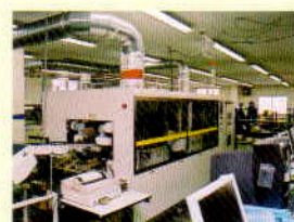
鉛フリーはんだ用の設備が並ぶ生産ライン（本社工場）
